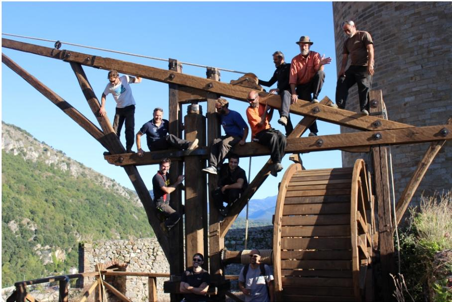
Ci-dessus: treuil à tambour ou cage à écureuil, dite "orientable", commande du Château des Comtes Foix réalisée sous la direction de Pascal Waringo.
